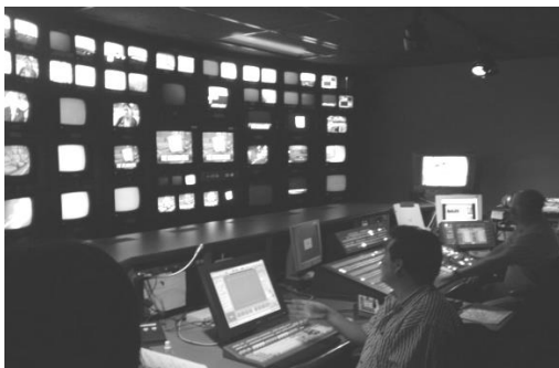
ภาพที่ 5 ห้องควบคุมการผลิตรายการ ( control room) ประกอบด้วยเครื่องมือต่าง ๆ เช่น Video switcher Audio mixer Video monitor เป็นต้น
