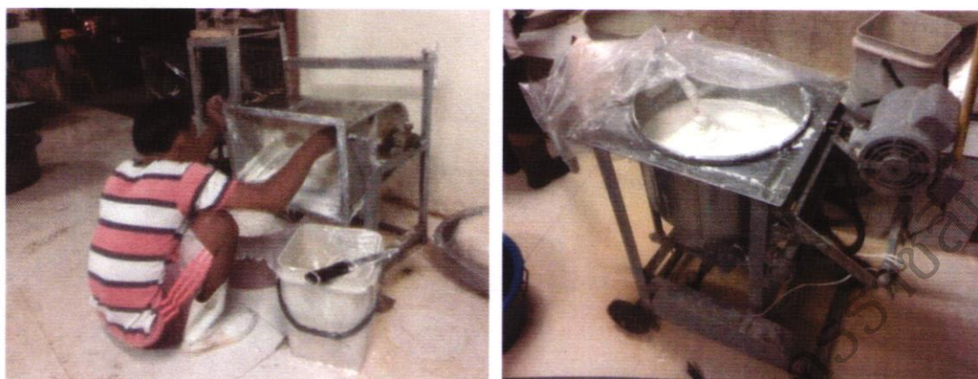
ภาพที่ 4.23-4.24 เครื่องตีแป้งหลังจากต้มแป้งแล้ว และเครื่องกรองแป้งหลังจากตีแป้งเรียบร้อยแล้ว ที่มา: ภาพถ่ายเมื่อ 23 กุมภาพันธ์ 2562.
